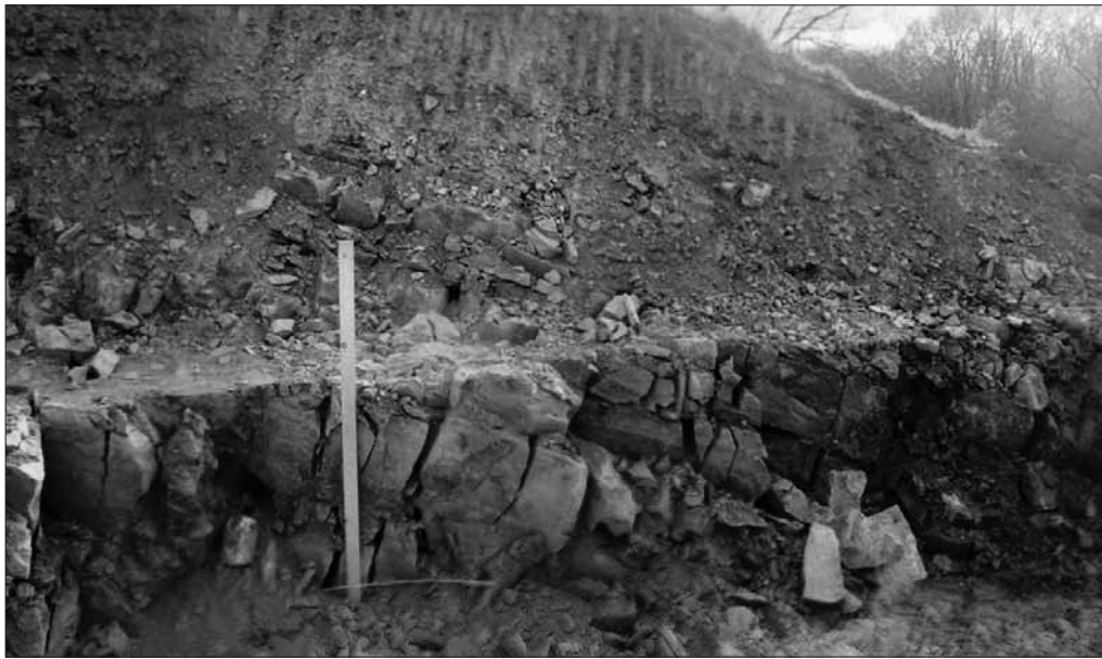
Blockdeformation im festen Plänermergel unter der Gehängelehmbdeckung im Hangsystem der Zschauke (Dresden-Bannewitz).
