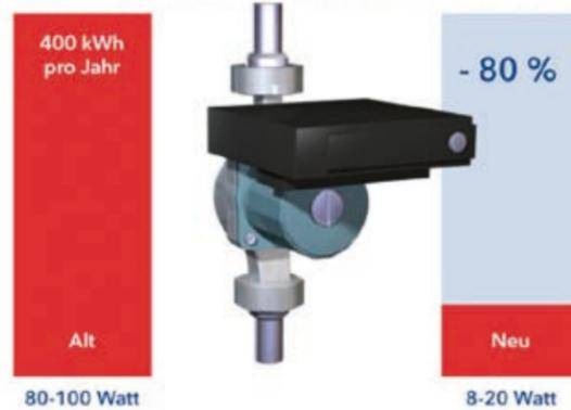
Hocheffizienzpumpen passen ihre Stromleistungsaufnahme automatisch den Druckverhältnissen im Rohrnetz an und senken erheblich den Energieverbrauch im Haus
