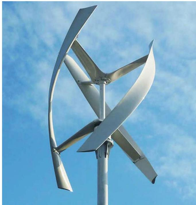
In den USA werden heute vorrangig vertikale Kleinwindkraftanlagen angeboten (im Bild der Firma UGE), die vergleichsweise leise rotieren und deren Wirkungsgrad selbst bei Schwachwind beachtlich ist.
