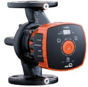
Neu entwickelte, wartungsfreie und hocheffiziente Nassläuferpumpen, z. B. von KBS, erfüllen die Effizienzanforderungen von 2015. Es gibt sie in 25 Baugrößen im Leistungsbereich 10 bis 175 W. Die kleinen Aggregate fördern bis zu 13 Kubikmeter Flüssigkeit pro Stunde auf eine maximale Förderhöhe von 10 Metern.
